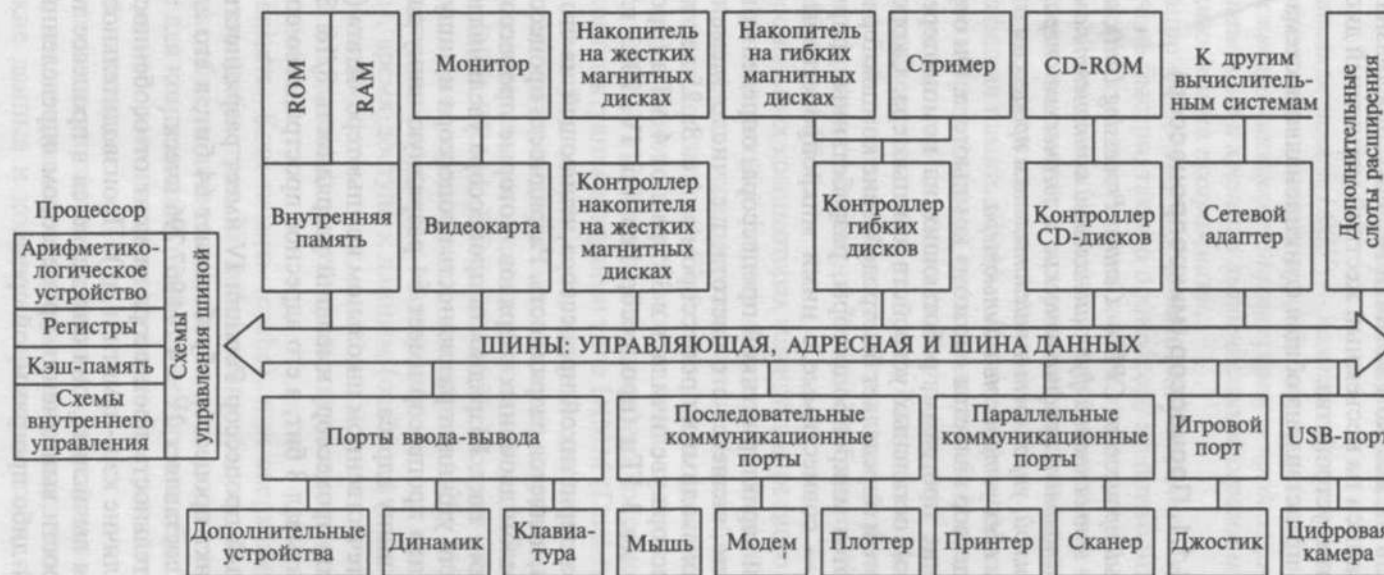
Рис. 3.2. Общая функциональная схема компьютера с подсоединенными периферийными устройствами
